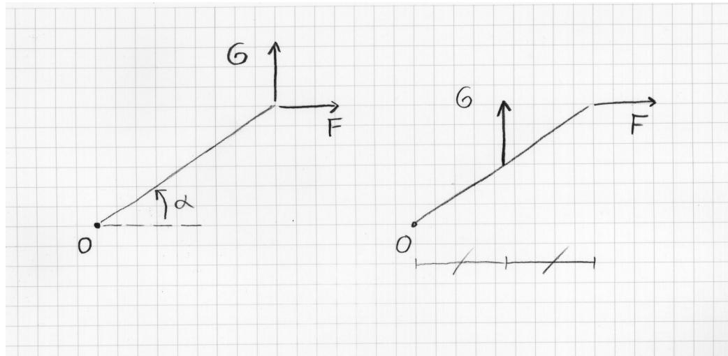
Le due leve sono libere di ruotare nell'estremo  $O$  ed hanno applicate delle forze  $F$  e  $G$  di direzione ed intensità fisse ( $|F| = |G|$ ). Determinare l'angolo  $\alpha$  per il quale si ha equilibrio.
