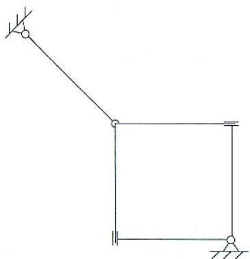
GDL = \_\_\_\_\_ ipostatica  isostatica
