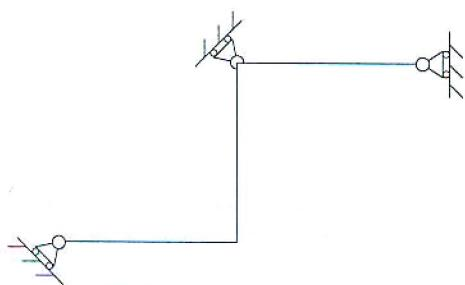
GDL = \_\_\_\_\_ ipostatica  isostatica
